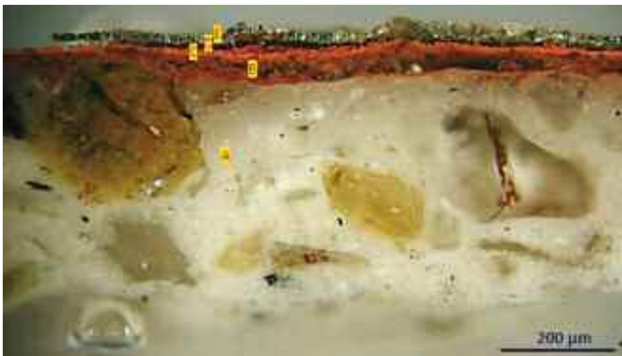
Figura 4 - Sezione stratigrafica dell'immagine precedente: è evidente la tecnica utilizzata nell'esecuzione del dipinto completata con una lamina di stagno applicata a missione. Le indagini sono state condotte presso il laboratorio C.S.G. Palladio di Vicenza.
