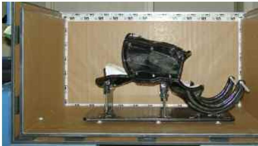
Figura 1 - Statua protetta da corpetto protettivo + doppia piastra protettiva + scatola sigillata ed isolate termicamente 4
