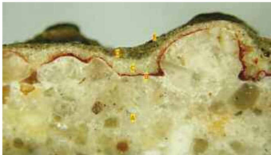
Figura 2 - Sezione stratigrafica dell'immagine precedente: è evidente la traccia disegnativa (sinopia) dal caratteristico colore rosso, dovuta da ocre rosse 80x.
