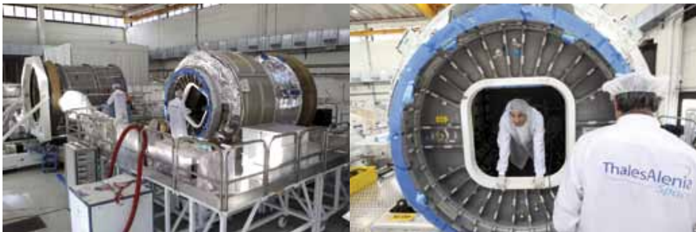
Figura 1 e 2 - Cygnus è un veicolo automatico, non adibito a trasporto di persone ma pressurizzato per poter essere connesso alla Stazione Spaziale Internazionale al fine di trasportare e consegnare carichi utili per gli astronauti della Stazione stessa che possono entrare in T-shirt nel modulo e prelevare gli equipaggiamenti di cui necessitano. Il modulo, quando viene rispedito a terra, viene riempito di rifiuti che si dissolvono con il modulo all'impatto con l'atmosfera.
