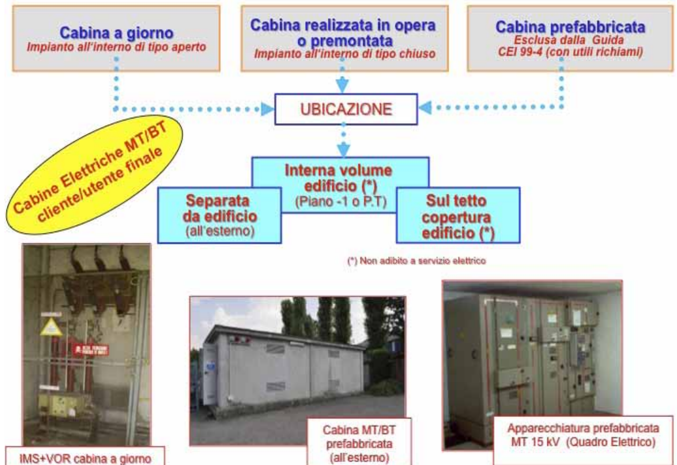
Figura 2 - Tipo e ubicazione Cabine Elettriche MT/BT
