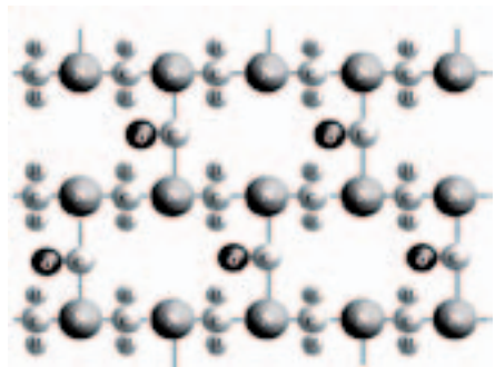
Figura 2 - Esempio della complessa struttura chimica di una resina ureica dopo l'indurimento finale. Si formano vari legami chimici (nell'esempio sono riportati solo alcuni di quelli possibili). Alcuni di questi legami sono forti, mentre altri sono più labili potendo quindi facilmente reagire con altre sostanze.
