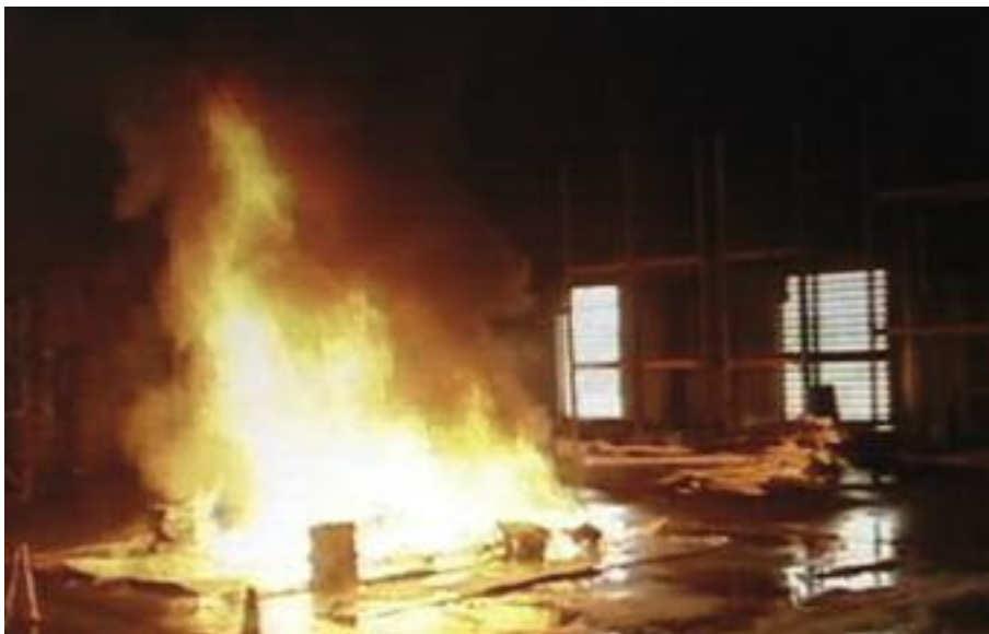
Figura 4 - Prove d'incendio con SEFC attivo
