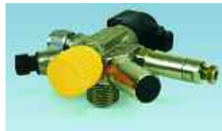
Moderna multi-valvola per bombole di metano veicolari omologata R110. Include una valvola manuale, una elettrovalvola, una valvola imitatrice di flusso ed un fusibile (PRD)
